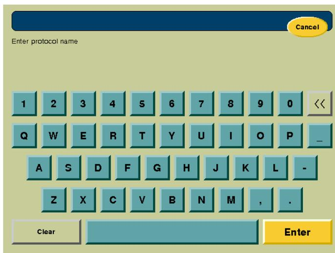
此时将显示一数字屏幕键盘，在题目框中会出现一闪烁的光标。可以键入包括空格在内的 20 个字母。用后退箭头以删除单个的字母，用 CLEAR 键删除整句。当预案的标题输入完了，可按 ENTER（输入）键。
