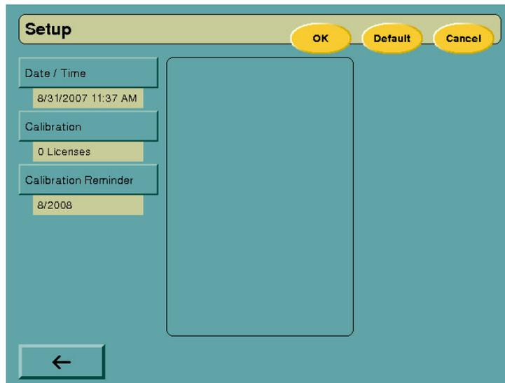
本系统提供校准和维护的提醒功能（**reminder**）。每次启动机器时在显示本系统图标屏幕上同时显示提醒功能。它在系统需要校准的前 30 天显示。从一次校准到下一次校准的间隔时间是由系统安装时或在选择校准提醒键（**calibration reminder**）输入的日期时决定的。
