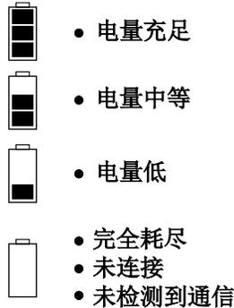
假如电池的图标上尚有一条横线，而电池没有更换时，则尚可以完成正在进行的注射。但是不能启动新的一次注射，不能控制注射器头的活塞前进和后退，另外机器的通讯也可能丧失。
