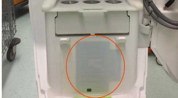
Abbildung 11 - 2: Füllstandsensor des Spülbehälters
