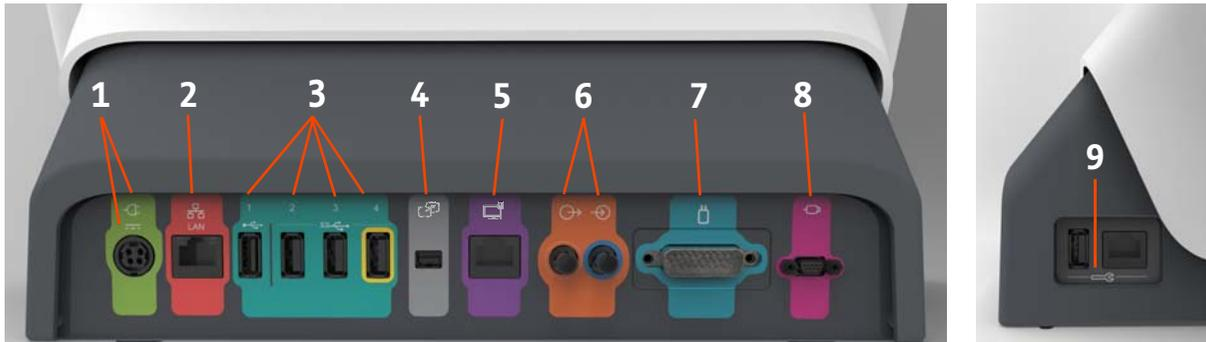
Abbildung 4 - 5: Steuerraeumeinheit, seitliche und ruckseitige Anschluesse
