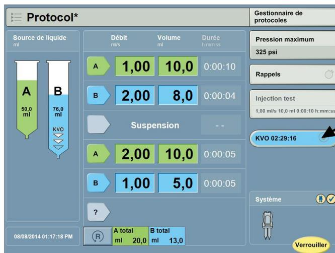
2. Le mode KVO peut être arrêté à tout moment en sélectionnant le bouton **KVO** après le lancement du mode KVO (allumé en bleu) ou en appuyant sur n'importe quel bouton de commande de la tête d'injection. Ceci désarme également le système et met fin à toute injection en cours.
